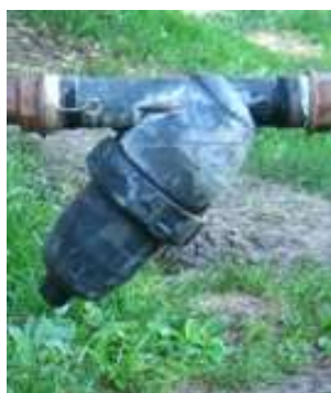
Fig. 23 Filtru: a. montajul pe conducta principala a instalației de udare localizată; b. componenta: 1, 3 – carcasa filtrului; 2 - filtru tip cu discuri; 4 – supapă de evacuare
