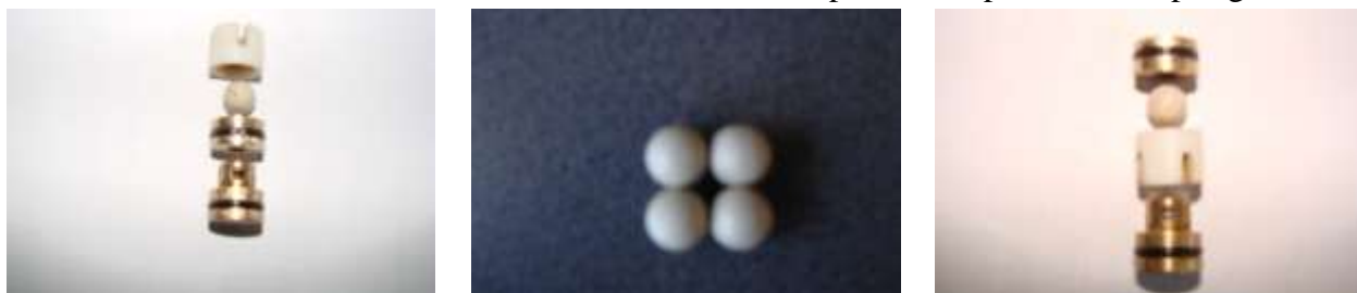
Fig.2 a-Supapă aspirație; b-Bile; c-Supapă refulare
